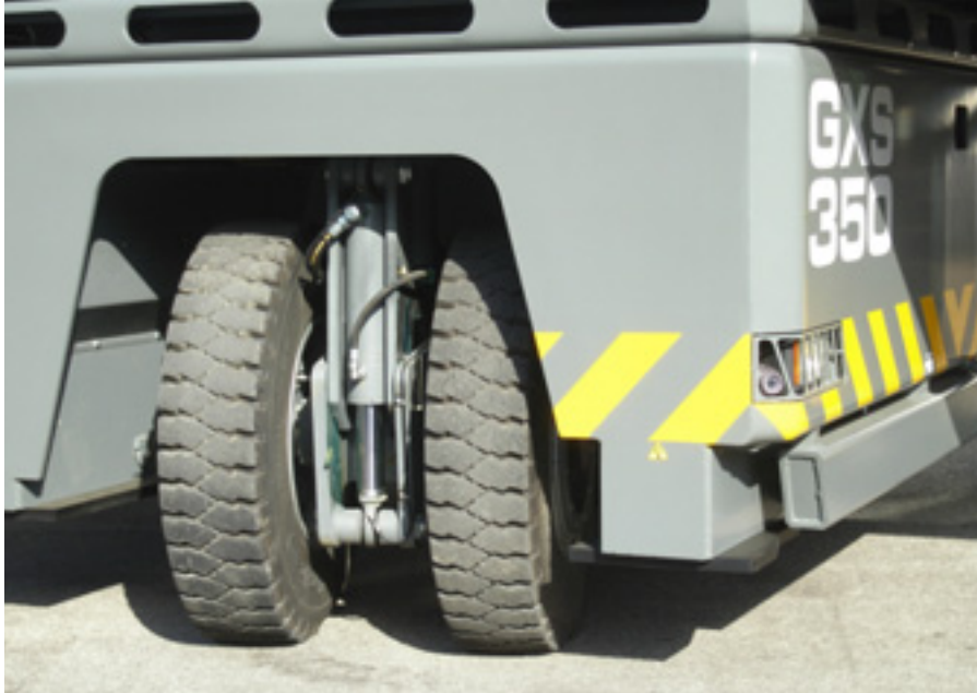
Maximale Manövrierbarkeit mit bis 90° eingeschlagenen Doppelrädern.
