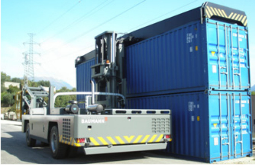
Anheben eines Containers mit dem Spreader.
