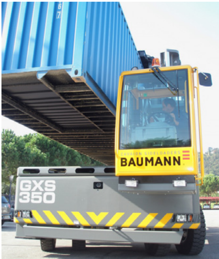
Der Baumann Container-Stapler mit 35 Tonnen Tragfähigkeit ist dafür ausgelegt, heikle Frachten in Containern zu transportieren. (Bilder: Feurstein)
