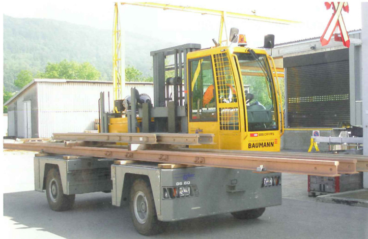
Der Baumann GS60 im BTC Hägendorf mit dem über Plattformniveau angeordneten Dieselmotor zeichnet sich durch hohe Servicefreundlichkeit aus. (Bild: Feurstein)
