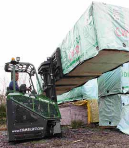
Combilift Combi CB ist für Lasten bis 2500 kg geeignet
