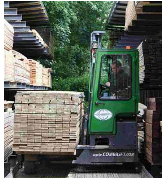
Größter Vorteil der Combilift C-Serie ist der flexible Einsatz als Front-, Seiten- und Vierwege-Stapler
