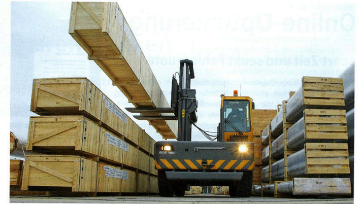
Komplexes Handling von langen Lasten: Plattformseitig angebrachte Neigezylinder gleichen Fahrbahn-Unebenheiten aus und halten so die Gabel mit der Last horizontal
