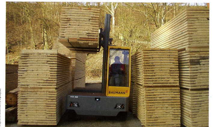
Schwere Last auf engstem Raum tragen die Baumann-Seitenstapler, die mit einer Standbreite von 2,2 m auch in engen Gängen das Handling von Lasten ermöglichen
