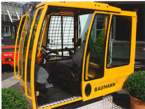
Optimierte Kabine mit großflächigen Fensterscheiben bietet Sicht auf Last und Fahrtrasse
